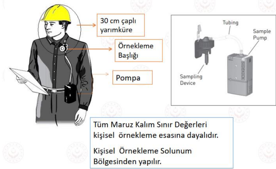
Şekil 3.1: Kişisel maruziyet ölçümünde cihazın ölçüm yapılacak kişiye bağlanması [9]
