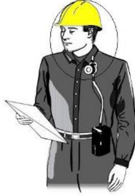
Şekil 3.5: Örnek kişisel maruziyet ölçümünde cihazın ölçüm yapılacak kişiye bağlanması
